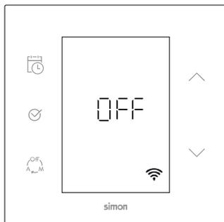
Når S100 iO termostaten blir koblet til strøm går den i standby (OFF) modus
