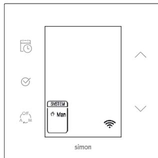
For å slå på termostaten, trykk tre ganger på P3 tasten. MAN ikonet blinker, trykk P2 for å bekrefte.
